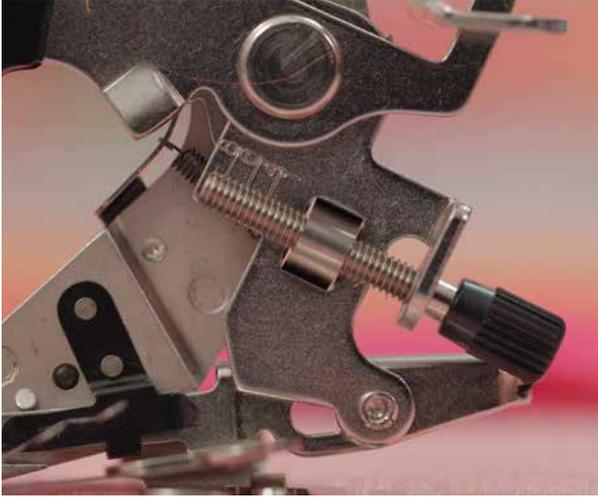
এইখানে এই কালো স্ক্রুটি হল রাফলিং ডেপ্ত স্ক্রু এবং এইটি আপনাকে সহয়তা করবে পেটসের ডেপ্তকে নিয়ন্ত্রণ করতে। ১ নম্বরটি হল খুব ছোট পেটসের জন্য, ৪, ৬ এবং ৮ আস্তে আস্তে বড় গভীর পেটস তৈরি করতে লাগবে।
